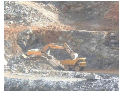
Escavadeira para carregamento da rocha desmontada nos caminhões basculantes
