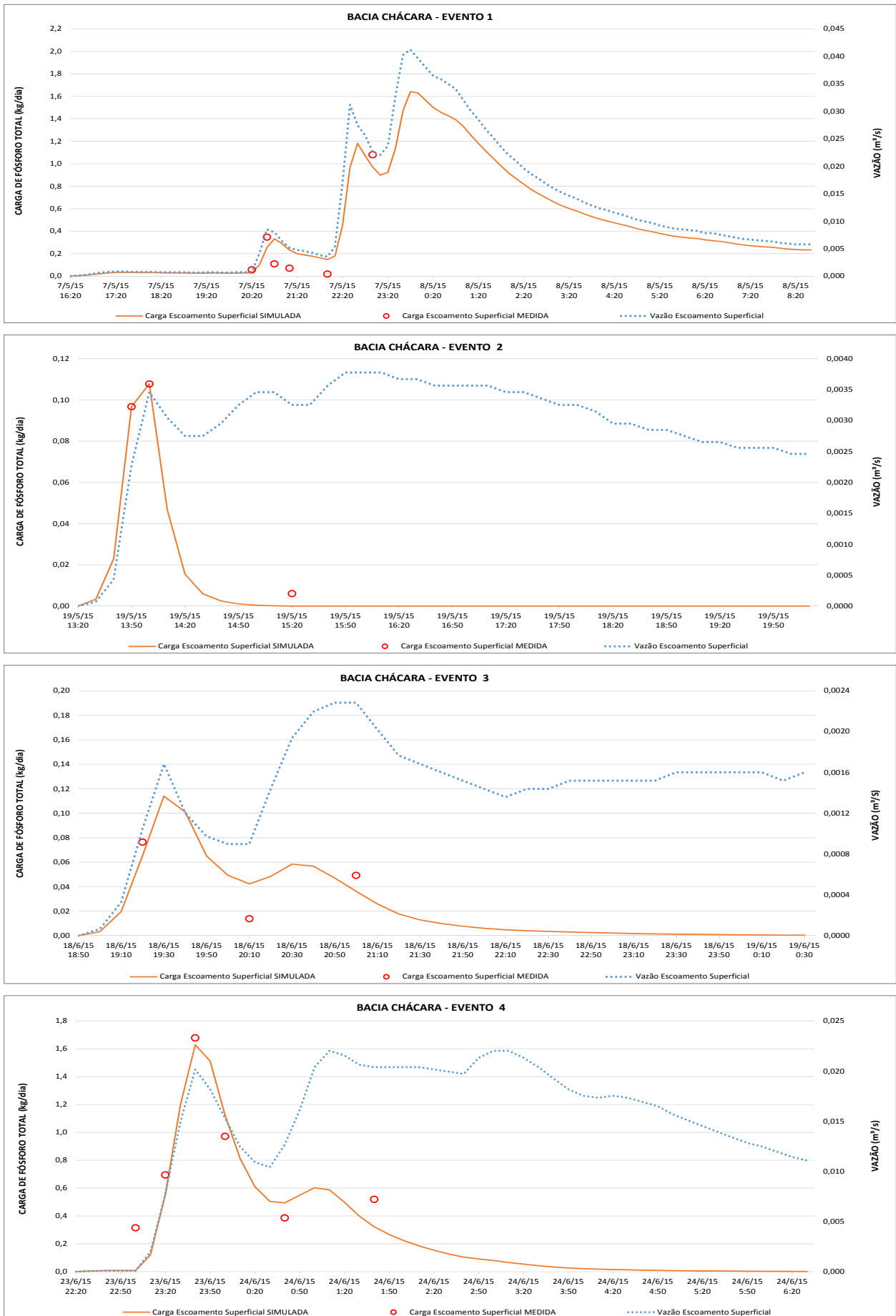
Figura 5.1-1 – Hidrograma e Polutograma de Eventos de Chuva na Bacia Chácara – Fósforo Total
