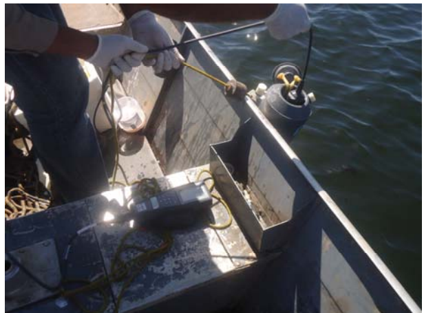
Garrafa de Van Dorn para coleta horizontal de amostra de água para determinação de perfil de OD e temperatura (realizado nos pontos G05 e G06)
