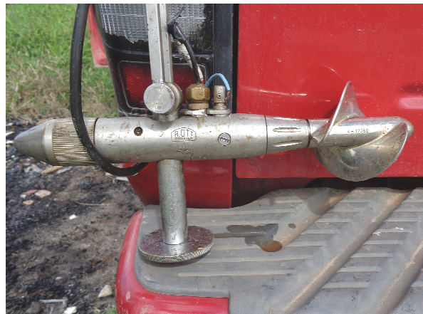
Típico conjunto hélice/molinete utilizado nas medições de vazão a vau
