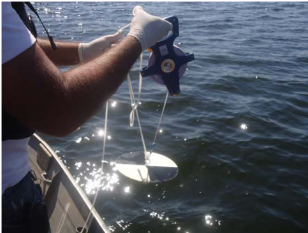
Medição da transparência da água com a utilização do Disco de Secchi
