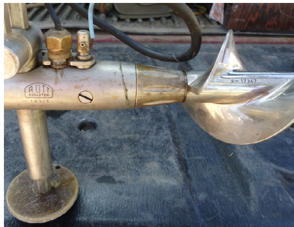
Conjunto hélice/molinete utilizado nas medições de vazão a vau
