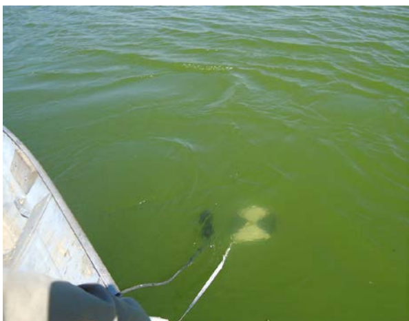
Medição de parâmetros (Multiparâmetros) e transparência (Disco de Secchi)
