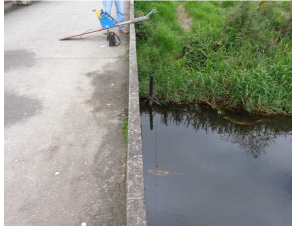
Algumas medições de vazão foram realizadas por guincho, nos pontos B28 e B26 (Rio Grande)
