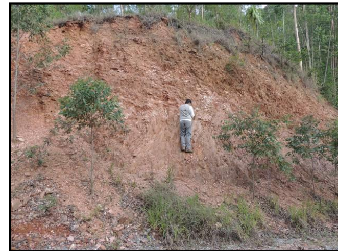
Corte em acesso ao depósito de estéril onde sobressai o filito e, cortando o corpo rochoso principal, ocorrem veios de quartzo, muitas vezes disseminados no horizonte A, formando um pavimento detrítico
