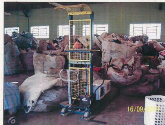
FOTO 2. ELEVADOR DE CARGAS
