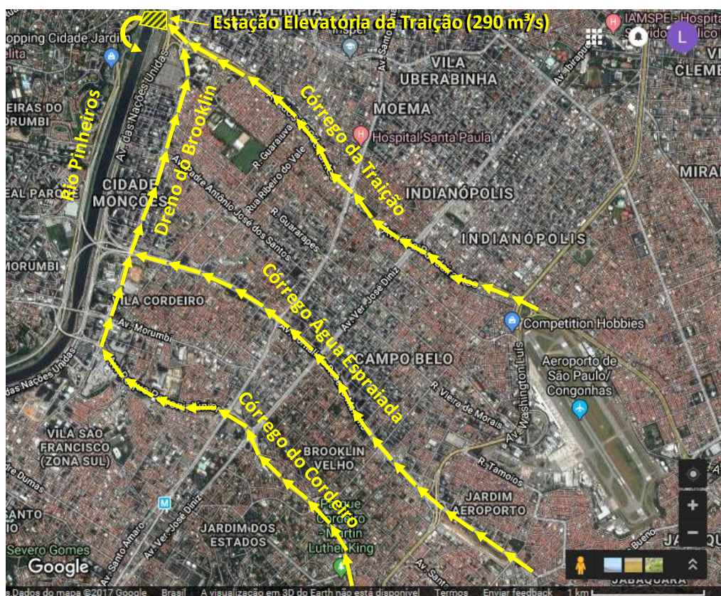
Figura 4.12 - Configuração Original do “Dreno do Brooklin” até a Década de 1990
