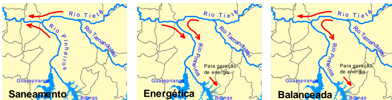
Figura 6.29 - Regras de operação do Sistema Alto Tietê
