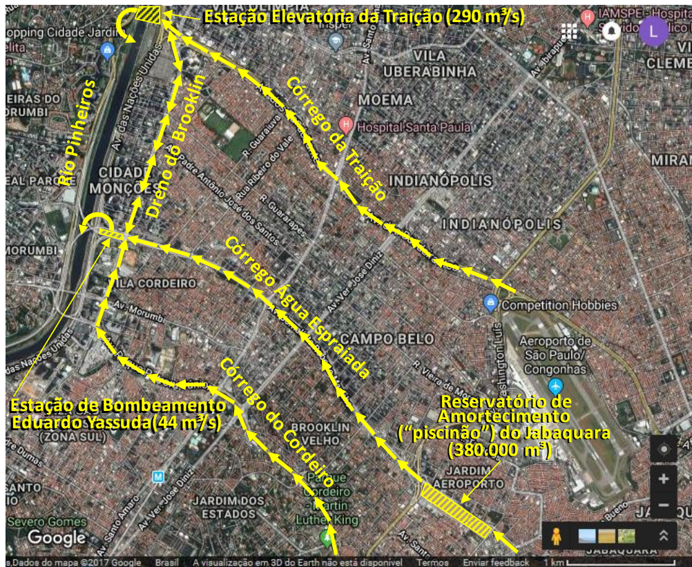
Figura 4.13 - Configuração Atual do “Dreno do Brooklin” com a estação de Bombeamento Eduardo Yassuda
