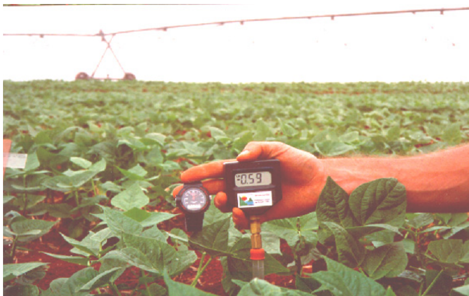
FIGURA 12 - Tensímetro realizando leitura do potencial mátrico (bar) em tensiômetro instalado sob pivô central na cultura do feijão.
